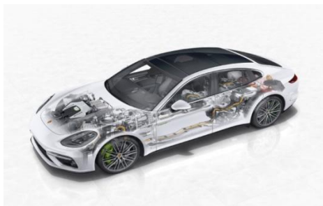
圖六：Porsche Panamera 油電混合系統圖
