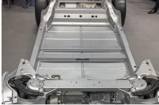
圖四：特斯拉電池版（內由 18650 鋰電池組成）
